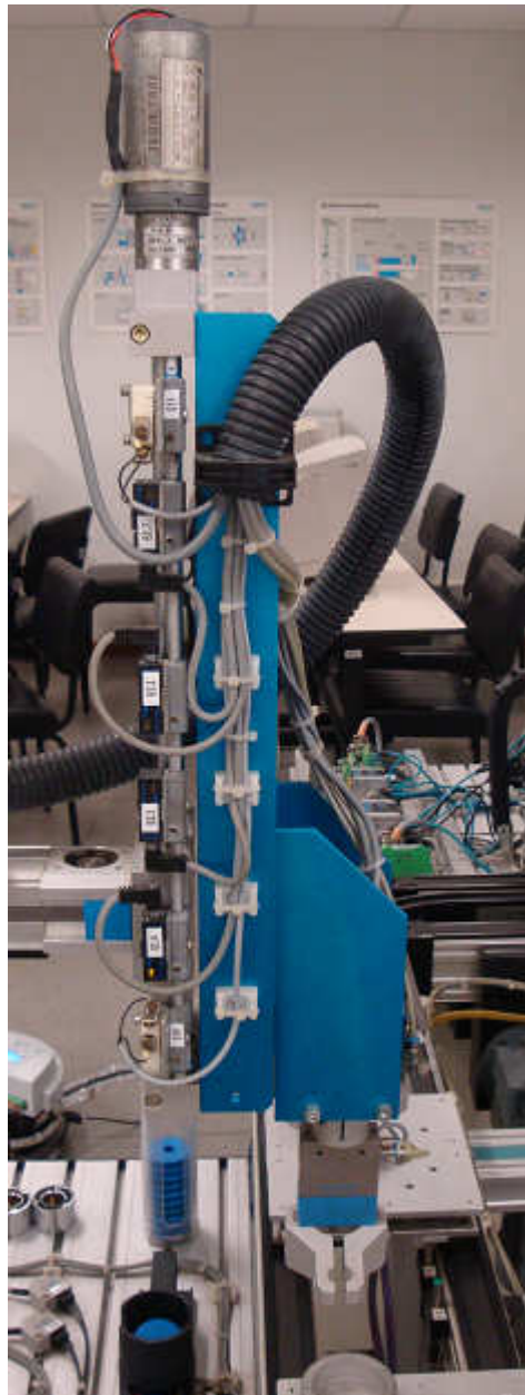
Figura 19. Eixo Z (Guia Z), sensores de posição e Garra Dedicada
